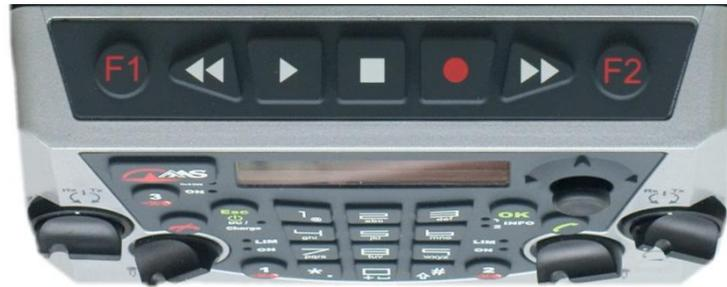
Figure 7 Clavier enregistrement
